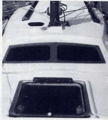
*Vista da prua con il passo d'uomo trasparente, la tuga slanciata con la doppia finestratura fissa, l'aeratore posto asimmetricamente sopra il vano del gabinetto e i tientibene comodi e ben dimensionati.*
